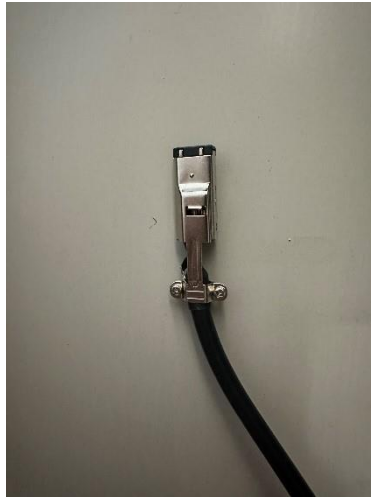
Figure 2-20. Cáp kết nối board I/O link loại có dây giáp và giáp được hàn lên vỏ connector
